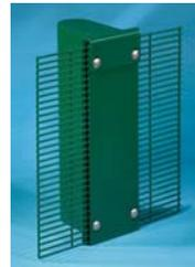
Das Design und die hohe Streckgrenze von Bekasecure Pfosten gewährleisten ultimative Eigenschaften in Bezug auf Sicherheit, Stabilität und Montagefreundlichkeit. Die Pfosten sind an der Front mit zwei Reihen Langlöchern 10 x 20 mm versehen. Die Gittermatten werden mit einer durchgehenden Abdeckleiste und Flachkopfschrauben mit Abrißmutter am Pfosten fixiert. Das offene Profil macht die Ausstattung mit Detektionskabeln sehr einfach. Sind die Pfosten einmal mit der Abdeck-
